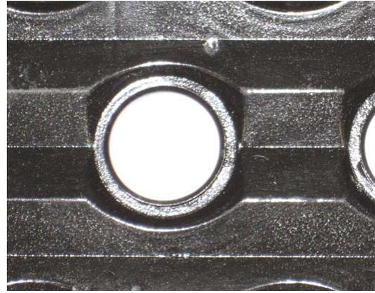
**Figura 44:** Fenólico negro después de 250hrs sumergido en una mezcla de .16% Sunny-Sol 150
