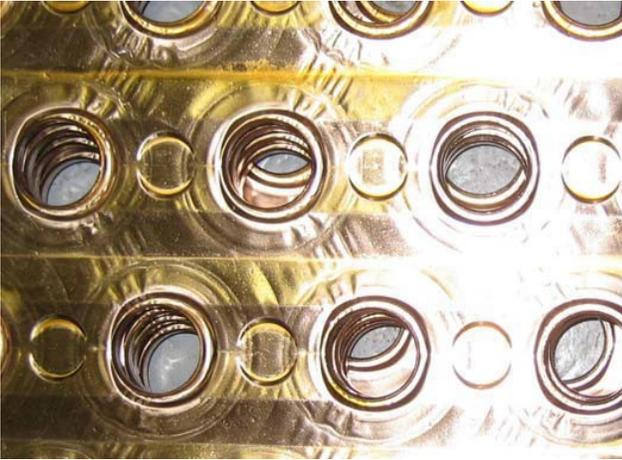
**Figura 22:** Muestra de cupronickel 95/5 antes de la prueba de corrosión.
