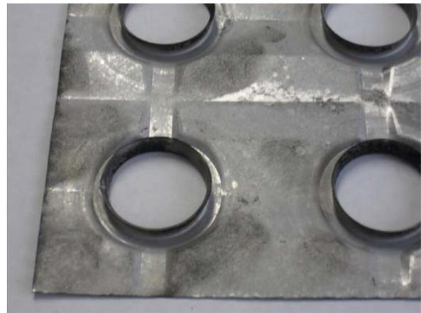
**Figura 59:** Aluminio 1100 después de 500hrs sumergido en una mezcla de 10% hidróxido de amonio.
