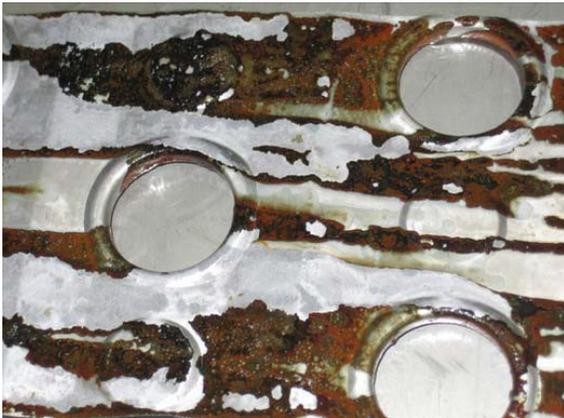
**Figura 13:** Acero al carbón después de 250hrs sumergido en una mezcla de .16% Sunny-Sol 150.
