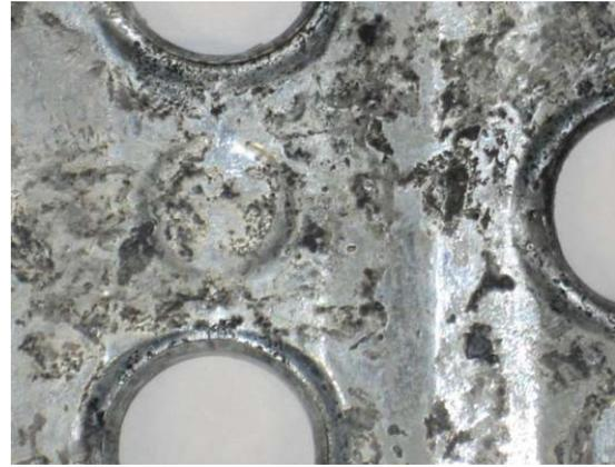
**Figura 53:** Acero galvanizado después de 250hrs sumergido en una mezcla de .16% Sunny-Sol 150.
