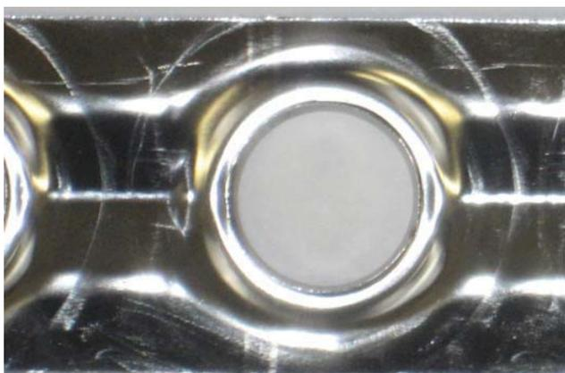
**Figura 39:** Acero inoxidable 304 después de 250hrs sumergido en una mezcla de .16% Sunny-Sol 150.
