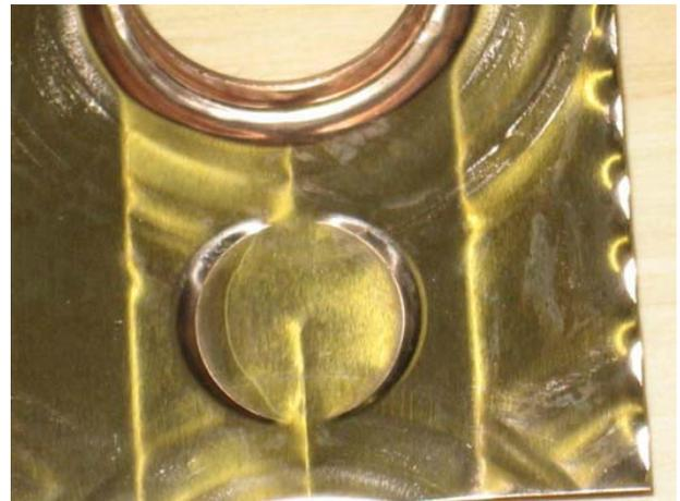
**Figura 26:** Cupronickel 95/5 después de 250hrs sumergido en una mezcla de 3.9% FRM 63-CB
