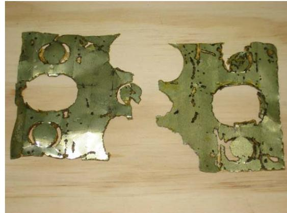
**Figura 30:** Aluminio epoxico después de 250hrs sumergido en una mezcla de 3.9% FRM 63-CB.
