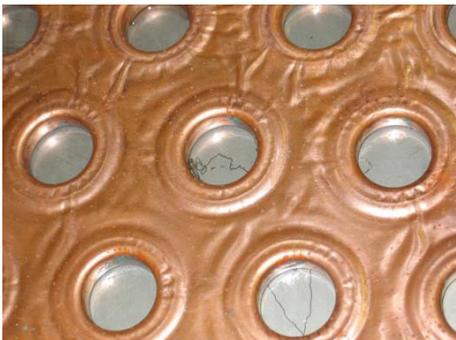
**Figure 3:** Cobre C11000 después de 250hrs sumergido en .16% Sunny-Sol 150 + Agua.
