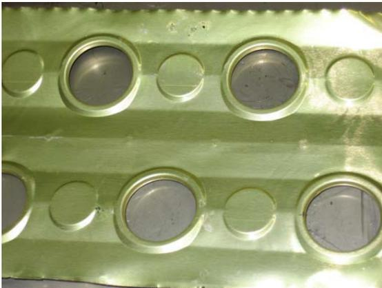
**Figura 28:** Aluminio epoxico después de 250hrs sumergido en una mezcla de .16% Sunny-Sol 150.
