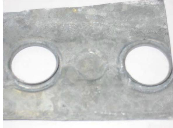
**Figura 58:** Acero galvanizado después de 500hrs sumergido en una mezcla de 10% hidróxido de amonio.
