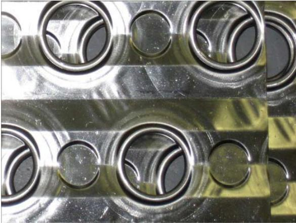
**Figura 17:** Muestra de acero inoxidable 316 antes de la prueba de corrosión.
