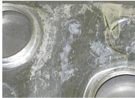
**Figura 9:** Aluminio 1100 después de 250hrs sumergido en una mezcla de .16% Sunny-Sol 150.
