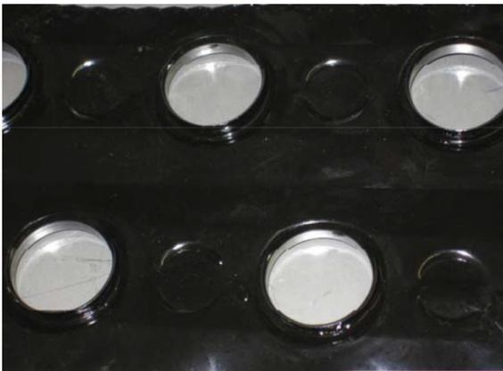
**Figura 33:** Aluminio Electrofin después de 250hrs sumergido en una mezcla de .16% Sunny-Sol 150.
