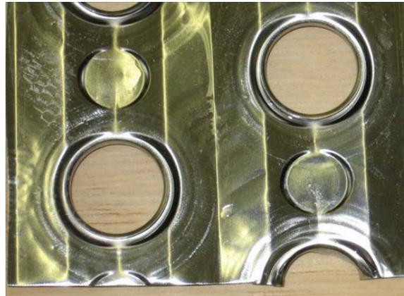
**Figura 20:** Acero inoxidable 316 después de 250hrs sumergido en una mezcla de 3.9% FRM 63-CB
