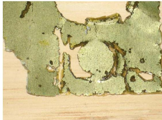
**Figura 31:** Aluminio epoxico después de 250hrs sumergido en una mezcla de 3.9% FRM 63-CB.
