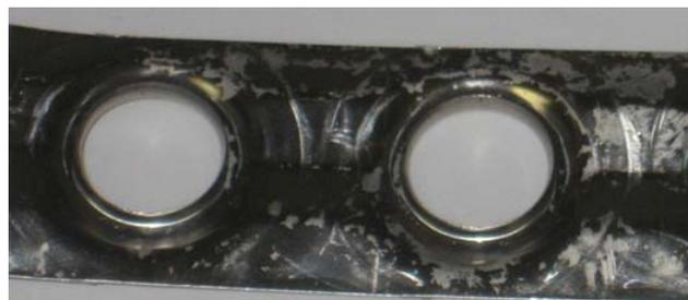
**Figura 41:** Acero inoxidable 304 después de 250hrs sumergido en una mezcla de 3.9% FRM 63-CB .
