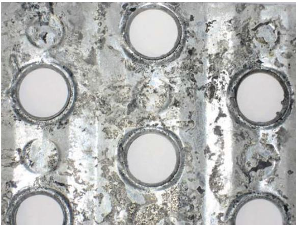
**Figura 52:** Acero galvanizado después de 250hrs sumergido en una mezcla de .16% Sunny-Sol 150.
