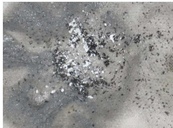
**Figura 10:** Aluminio 1100 después de 250hrs sumergido en una mezcla de 3.9% FRM 63-CB.
