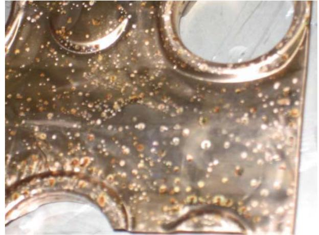
**Figura 24:** Cupronickel 95/5 después de 250hrs sumergido en una mezcla de .16% Sunny-Sol 150.
