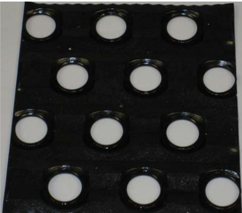
**Figura 43:** Fenólico negro después de 250hrs sumergido en una mezcla de .16% Sunny-Sol 150.
