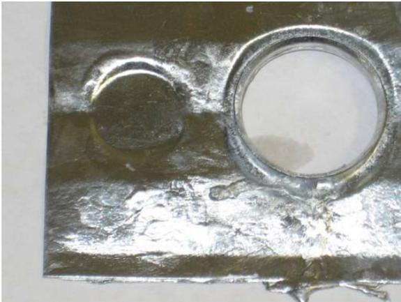
**Figura 51:** Muestra de acero galvanizado antes de la prueba de corrosión.
