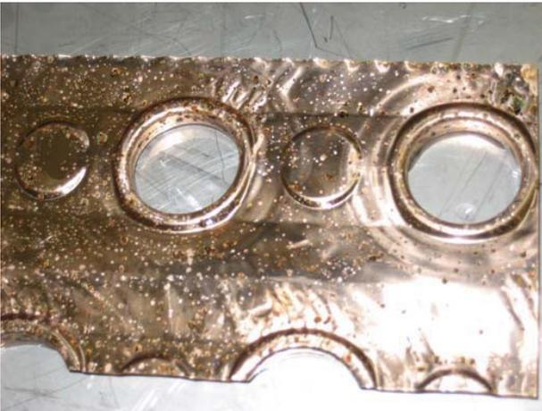
**Figura 23:** Cupronickel 95/5 después de 250hrs sumergido en una mezcla de .16% Sunny-Sol 150
