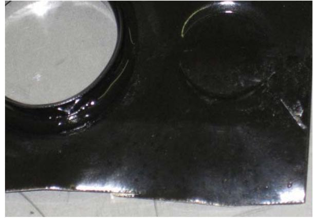
**Figura 34:** Aluminio Electrofin después de 250hrs sumergido en una mezcla de .16% Sunny-Sol 150.
