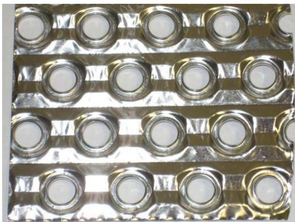
**Figura 47:** Muestra de Aluminio 5052 antes de las pruebas de corrosión.
