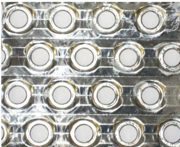
**Figura 48:** Aluminio 5052 después de 250hrs sumergido en una mezcla de .16% Sunny-Sol 150.
