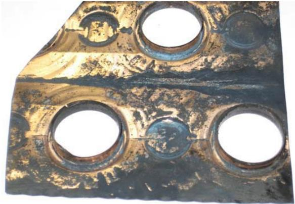
**Figura 56:** Cupronickel 95/5 después de 500hrs sumergido en una mezcla de 10% hidróxido de amonio.
