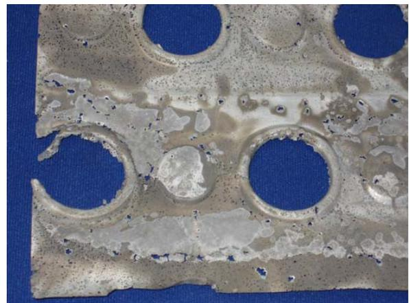
**Figura 11:** Aluminio 1100 después de 60hrs sumergido en una mezcla de 3.9% FRM 63-CB.
