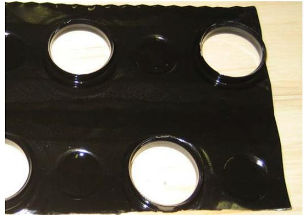
**Figura 35:** Aluminio Electrofin después de 250hrs sumergido en una mezcla de 3.9% FRM 63-CB.
