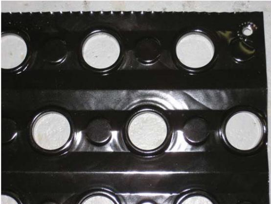
**Figura 32:** Muestra de aluminio Electrofin antes de la prueba de corrosión.
