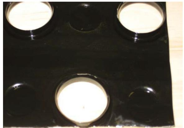
**Figura 36:** Aluminio Electrofin después de 250hrs sumergido en una mezcla de 3.9% FRM 63-CB.
