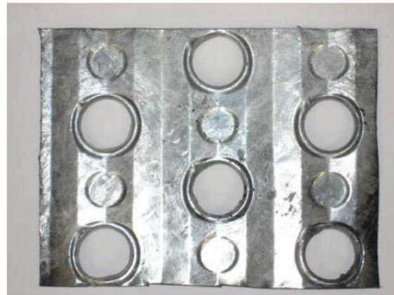
**Figura 54:** Acero galvanizado después de 250hrs sumergido en una mezcla de 3.9% FRM 63-CB.
