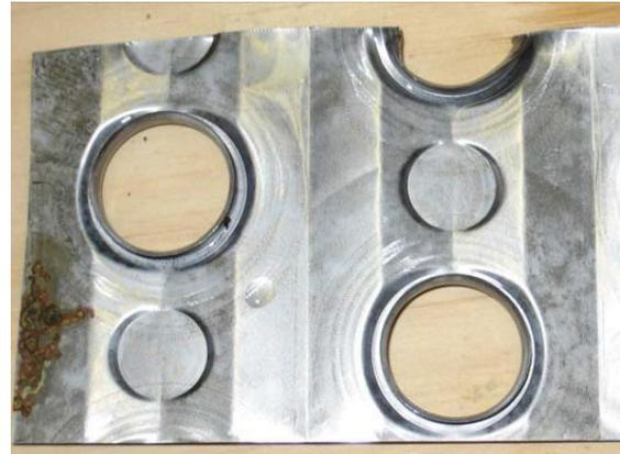
**Figura 15:** Acero al carbón después de 250hrs sumergido en una mezcla de 3.9% FRM 63-CB.
