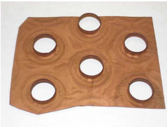
**Figura 57:** Cobre C11000 después de 500hrs sumergido en una mezcla de 10% hidróxido de amonio.
