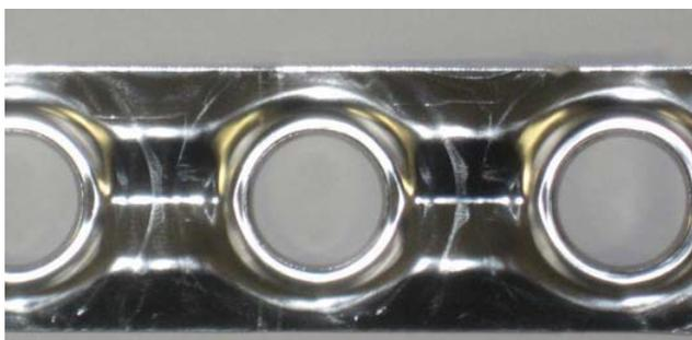
**Figura 38:** Acero inoxidable 304 después de 250hrs sumergido en una mezcla de .16% Sunny-Sol 150.
