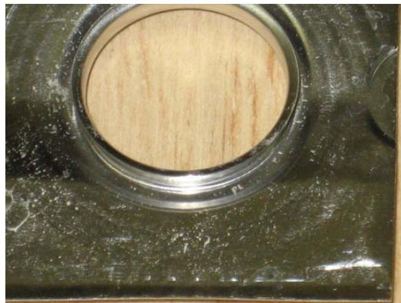
**Figura 21:** Acero inoxidable después de 250hrs sumergido en una mezcla de 3.9% FRM 63-CB.
