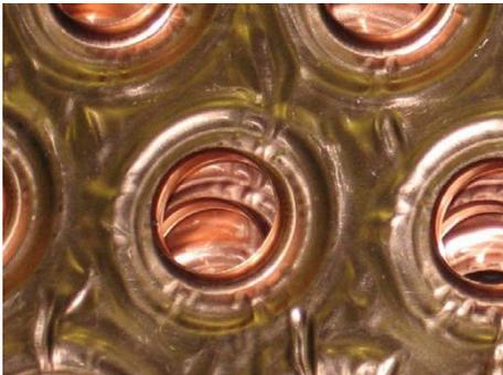
**Figure 2:** Cobre C11000 antes de la prueba de corrosión.
