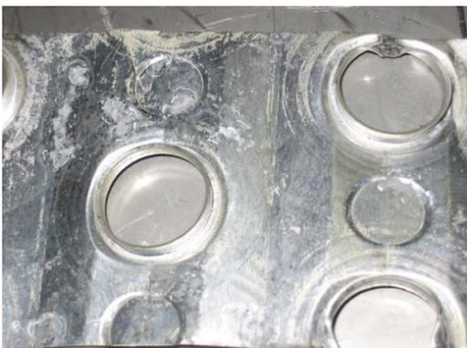
**Figura 8:** Aluminio 1100 después de 250hrs sumergido en una mezcla de .16% Sunny-Sol 150.
