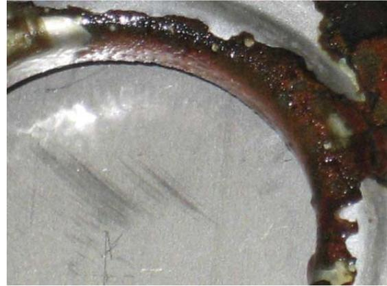
**Figura 14:** Acero al carbón después de 250hrs sumergido en una mezcla de .16% Sunny-Sol 150
