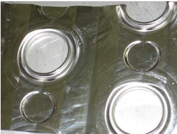
**Figura 18:** Acero inoxidable 316 después de 250hrs sumergido en una mezcla de .16% Sunny-Sol 150.
