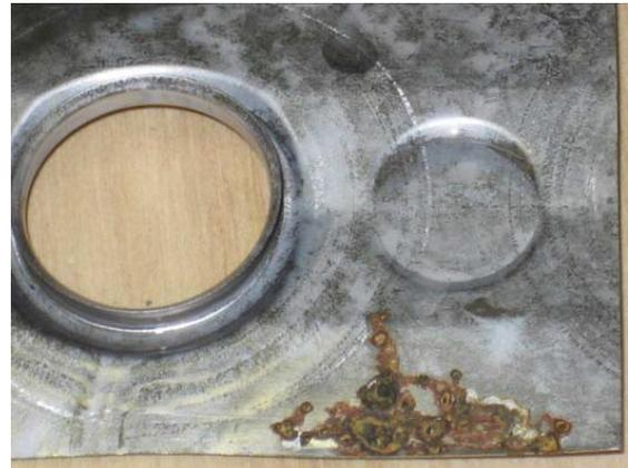
**Figura 16:** Acero al carbón después de 250hrs sumergido en una mezcla de 3.9% FRM 63-CB
